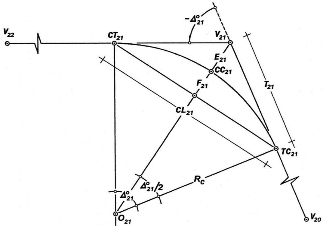
Figura 30 Principales elementos geométricos de la Curva Circular Simple
