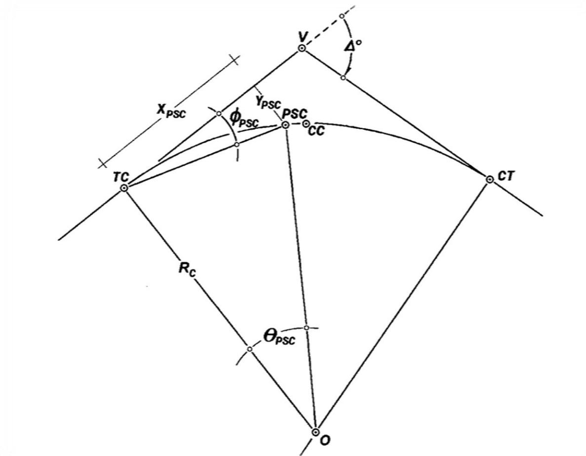
Figura 31 Elementos geométricos de replanteo (polares y cartesianos) para el Arco Circular Simple. Sin escala.
